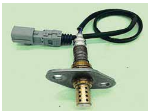
Рис. 2 Датчик контроля состава отработавших газов систем выпуска двигателя внутреннего сгорания и схема его реализации
