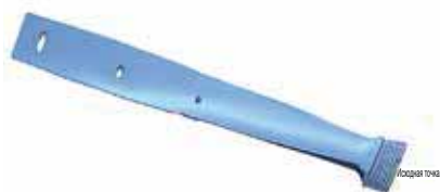
Рис. 8 Результат сканирования лопатки на ручной лазерный сканер Simscan
