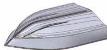
Рис. 11 Результат реверс-инжиниринга лодки
