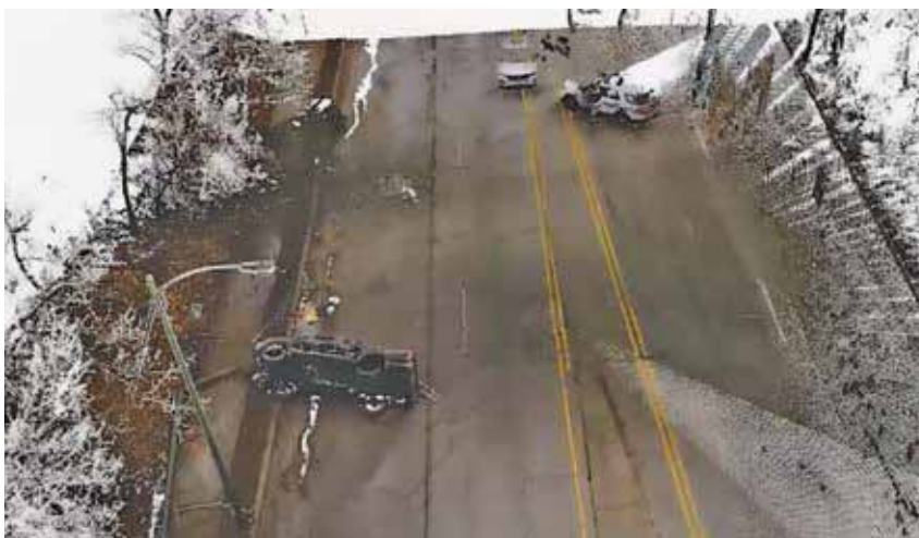
Рис. 3 Результат сканирования ДПП с использованием технологии дальнометрии
