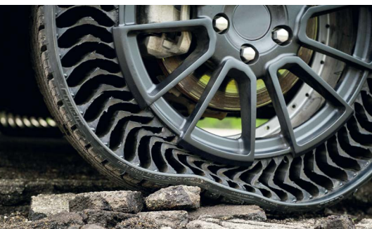
Рис. 8. Пример UPTIS шины от Michelin
