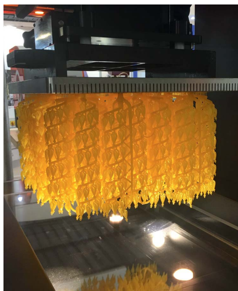
Рис. 12. Пример массового изготовления моделей для литья по выплавляемым моделям: а) напечатанные «елки» с моделями (около 4000 штук) на принтере DWS 030J; б) отливка напечатанной «елки»
