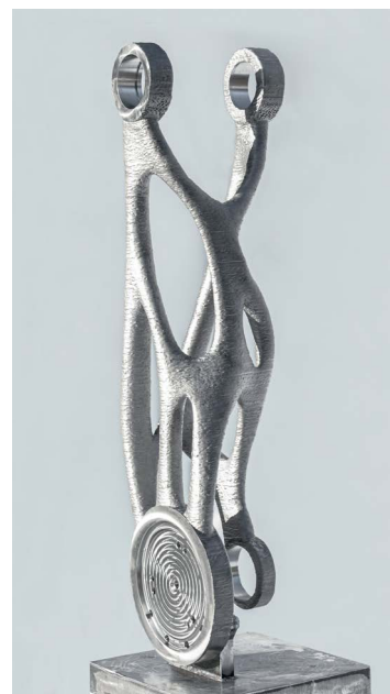
Рис. 14. Рука промышленного робота, напечатанная в соответствии с требованиями (DfAM), компания MX3D (Дания). Вес напечатанной детали вдвое ниже первоначальной.
