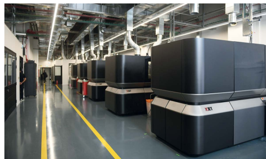
Рис. 18. Линейка машин XJET для производства керамических изделий
