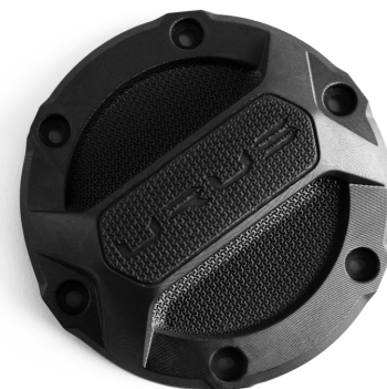
Рис. 7. Вентиляционный короб (а) на панели Lamborghini SiánS (b), напечатанный на принтере L1 Carbon
