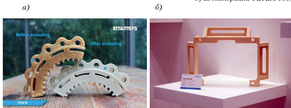
Рис. 23. Напечатанные детали: а) из материала PEEK до отжига (слева) и после, б) из материала ULTEM 9085
