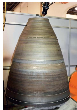
Рис. 2. Полноразмерный макет сопла ЖРД, изготовленный из жаропрочного сплава
