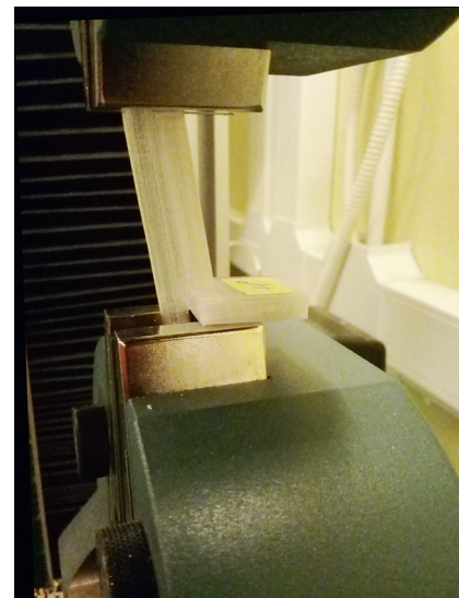
д) установка образца в захватах испытательной машины
