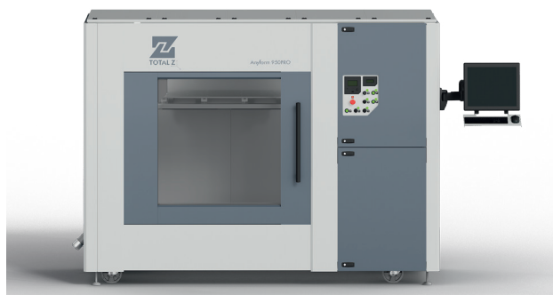
Рис. 2. Anyform 650-PRO компании TOTAL Z для печати высокотемпературными пластиками
