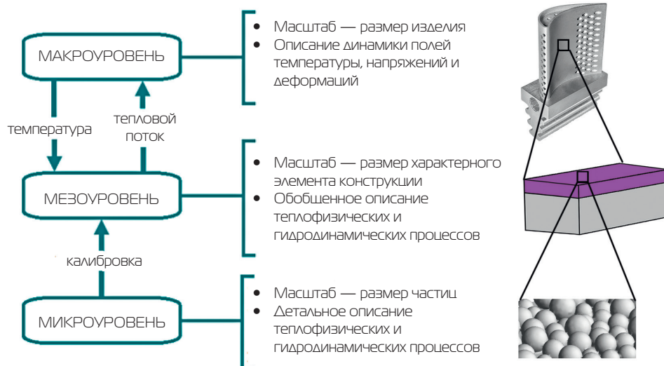
Рис. 1. Структура методологии многоуровневого моделирования СЛС-процессов
