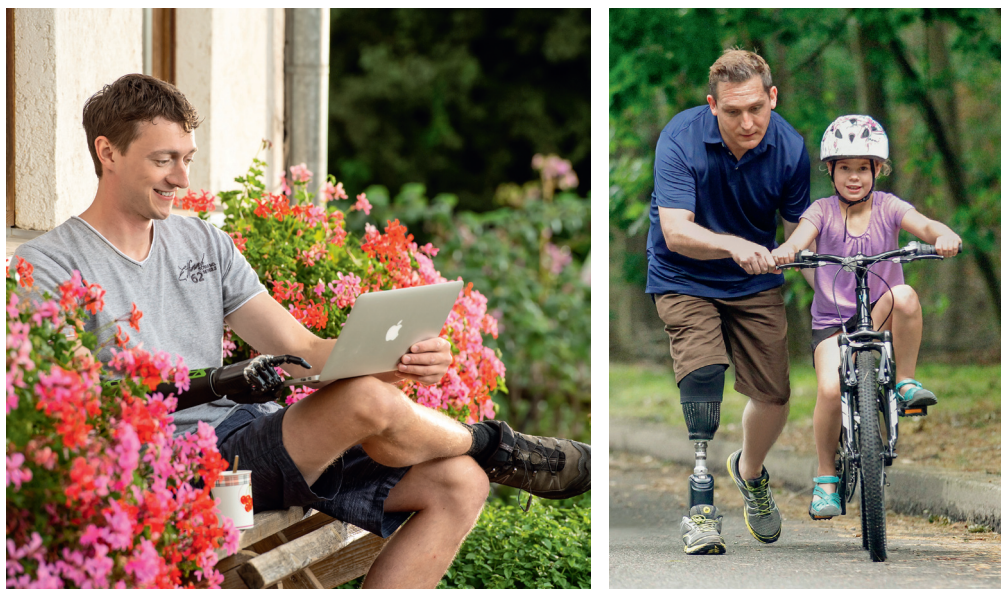
Рис. 3. Биопротезы конечностей компании Ottobock ( www.ottobock.com/en/ ): руки, управляемой командами головного мозга, которые считываются датчиками на руке с протезом и приводят в движение соответствующие приводы кисти и пальцев (а), ноги с управлением опциями (б)
