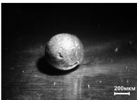
Рис. 4. Трехкратное облучение одного слоя порошка
