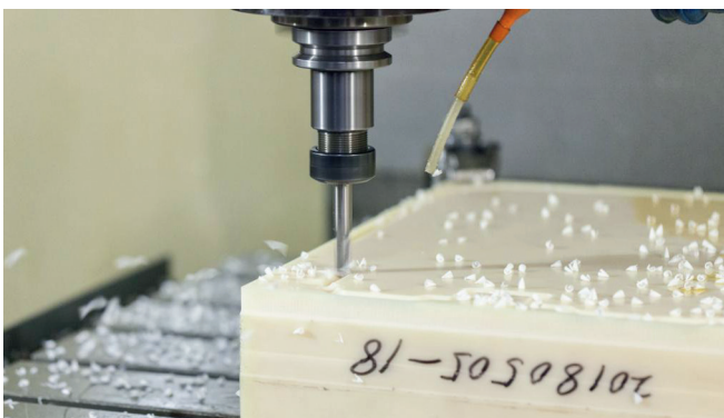
Рис. 1. При работе на станке потребовалось изготовить 25 секций изделия, а затем склеить их
