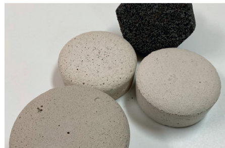
Рис. 15. Геополимер на основе крошки гранита и базальта
