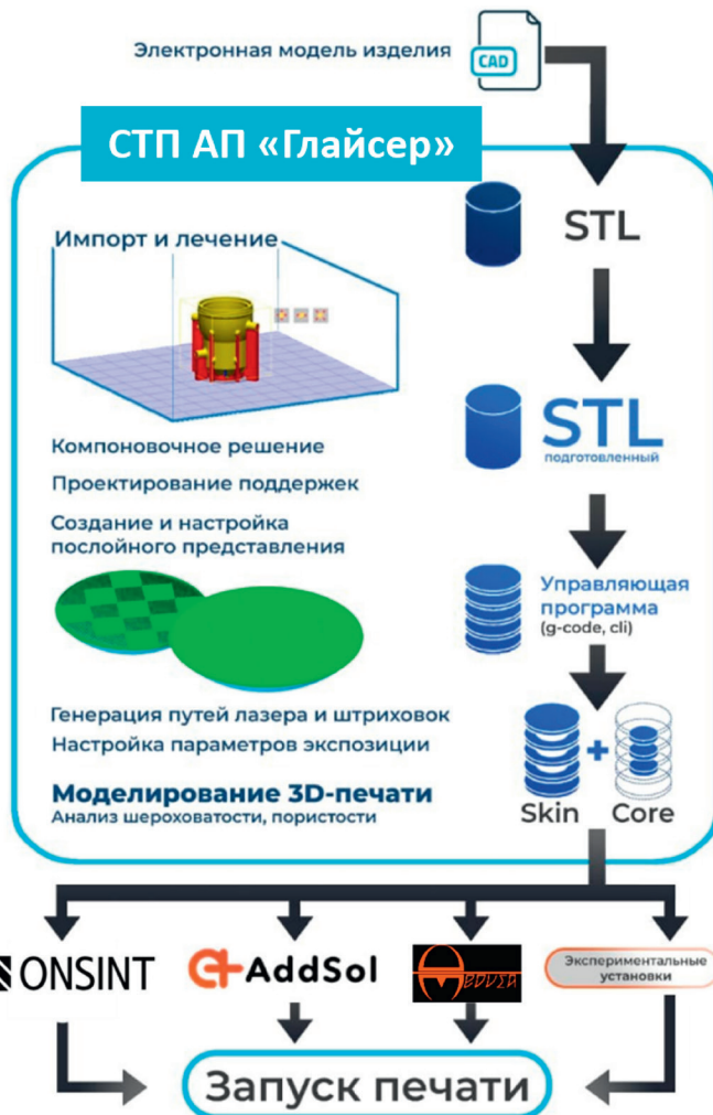
Рис. 6. Реализуются перспективные подходы к проектированию поддержек и управлению пересечением поддержек с телом модели в ПО «Глайсер». Фото представлены компанией AddSol
