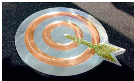
Рис. 9. Демонстрационный ММ образец возможности 3d-печати тремя материалами по технологии UAM (фото: Fabrisonic LLC, США)
