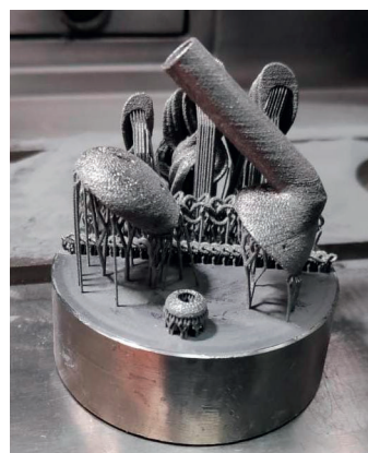
Рис. 5. Пример проектирования бионических оптимизированных поддерживающих структур для печати из титановых МПК в ПО «Глайсер». Фото представлены НИТУ МИСИС.
