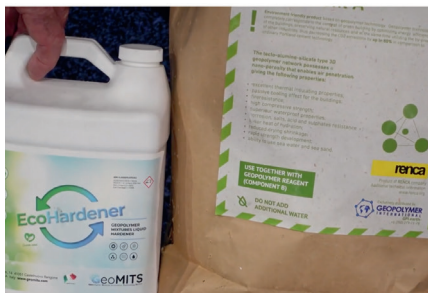
Рис. 13. Геополимер для использования переработанной пробки и придания ей огнестойкости
