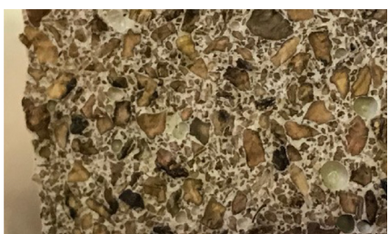
Рис. 13. Геополимер для использования переработанной пробки и придания ей огнестойкости
