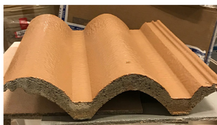
Рис. 14. Напечатанный блок черепицы с нанесенным огнезащитным слоем
