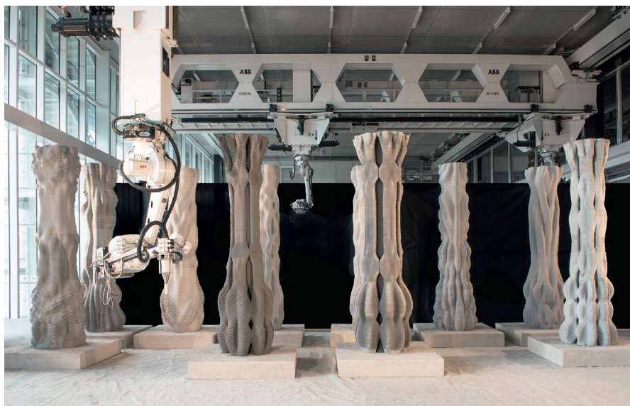
Рис. 26. Роботизированная система, используемая для создания колонн Concrete Choreography
