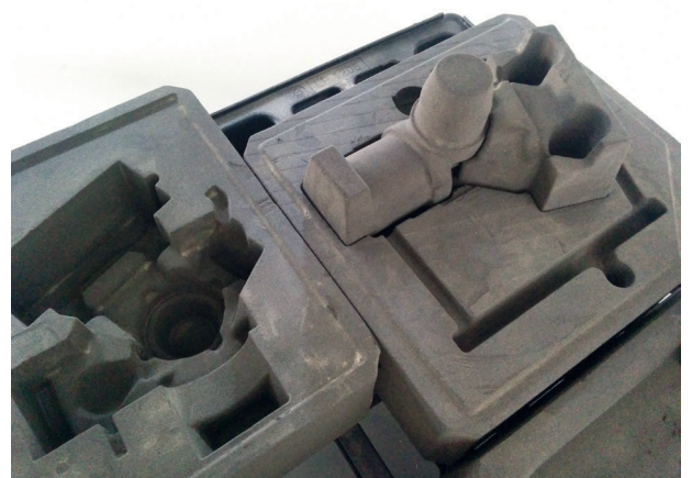
Рис. 6. Литейные формы, напечатанные на 3D-принтере ExOne S-MAX. Фото: http://kcdt.ru/
