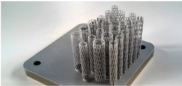
Рис. Артериальные стенты из нитинола, построенные вертикально практически без поддерживающих структур (CSIRO)
