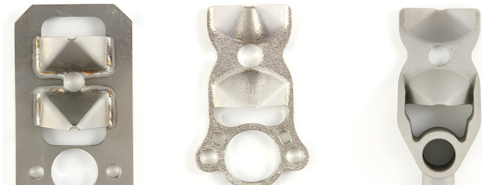
Рис. Эволюция дизайна кронштейна: а) старая конструкция детали, б) прототип, в) оптимизированная и технологически выверенная форма кронштейна под серийное аддитивное производство (Materialise)
