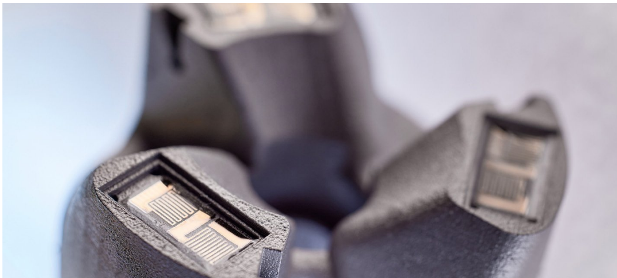
Рис. 3. Пример встраивания датчиков для измерения нагрузки и состояния твердосплавных режущих пластин (Fraunhofer ILT / Фолькер Ланнерт)
