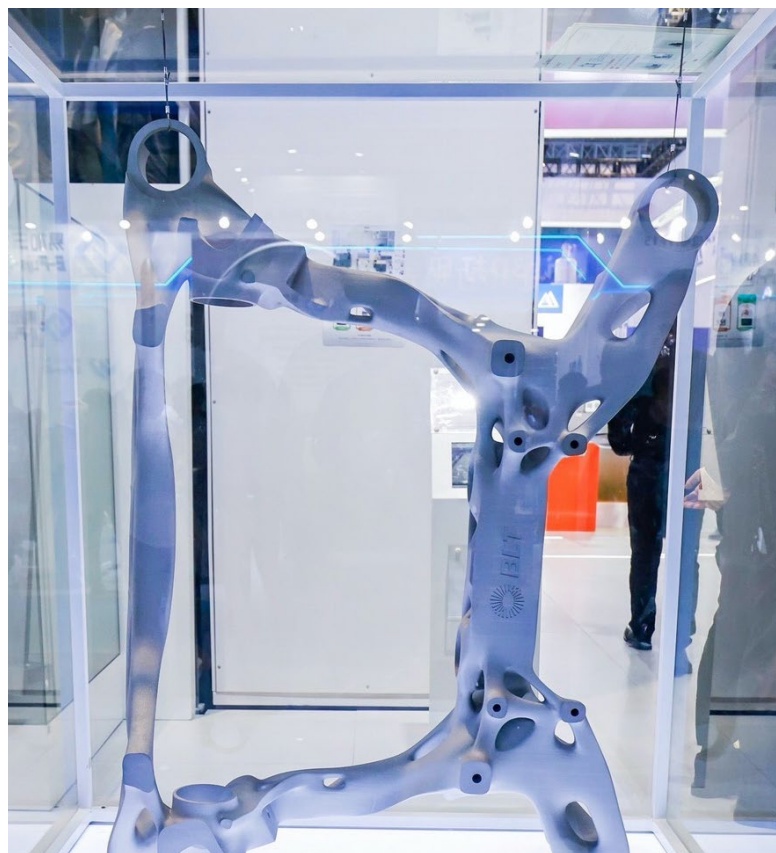
Фото: напечатанный алюминиевый подрамник электромобиля с решетчатой структурой с толщиной стенок 2 мм и на 20% легче, чем литой. Размеры детали: 1230 x 845 x 337 мм (с разрешения BLT)
