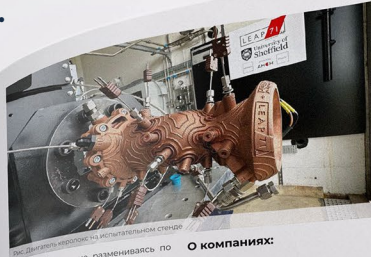
ИИ-двигатель керолокс с испытательном стенде
