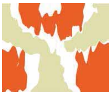
Рис. 1 2010–2011 годы – синхронное наблюдение концентраций водорода, гелия, кислорода и азота с помощью прибора «РИМС-1» на высоте 810–830 км. По горизонталям показаны годовые циклы 0–365 дней, по вертикали – широты
