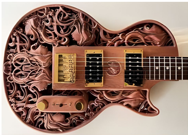
Рис. Корпус гитары, изготовленный методом 3D-печати, и детали, произведённые традиционным способом – все прекрасно живут вместе!
