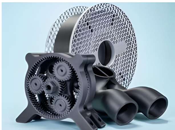
Рис. Стойкие к химическому воздействию детали, изготовленные из PA11, полученного из клешивины, с армированием углеродным волокном
