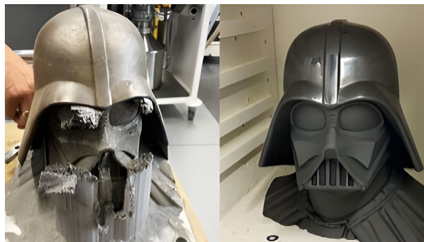
Рис. Металлический шлем Дарта Вейдера во время удаления поддержек (слева) и после термообработки и полировки (справа)
