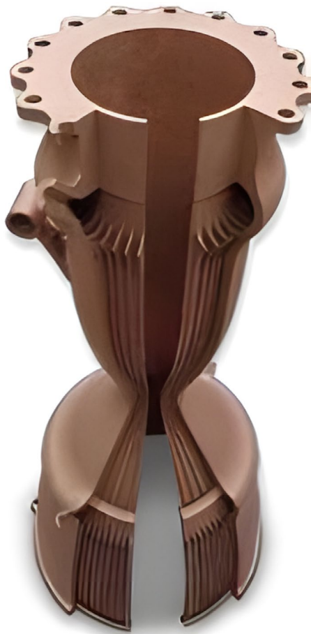
Рис. Ракетное сопло из медного сплава GRCop-42, разработанного NASA для АП
