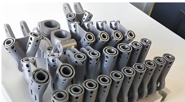
Рис. Металлические детали с минимальным количеством поддержек и максимально плотной компоновкой площади платформы
