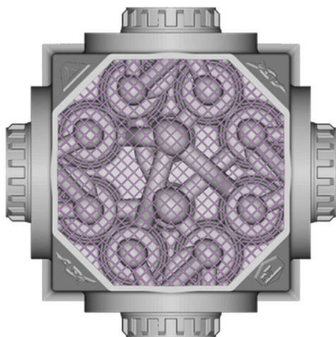
Рис. Возможности неявного моделирования nTop, с помощью которых масса корпуса форсунки Aerojet Rocketdyne была уменьшена в 2 раза. Источник: Velo3D
