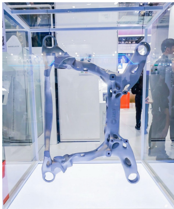
Рис. Титановый кронштейн с радикальным снижением времени построения с 36 до 19,5 часов (BLT)
