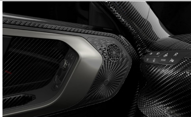
Рис. Напечатанная алюминиевая решетка Morel в Cizinger 21C
