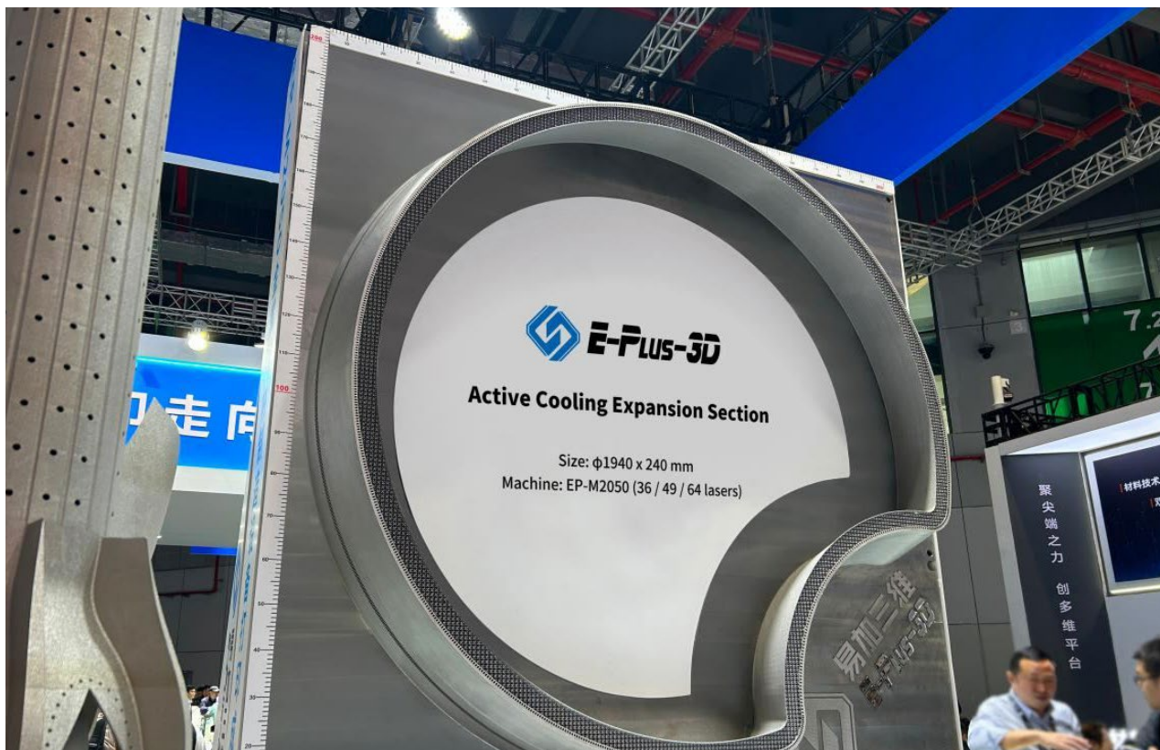
Рис. Часть системы активного охлаждения диам. 1940×240 мм, напечатанная на EP-M2050. Обратите внимание на ячеистые структуры в теле детали (Eplus3D)
