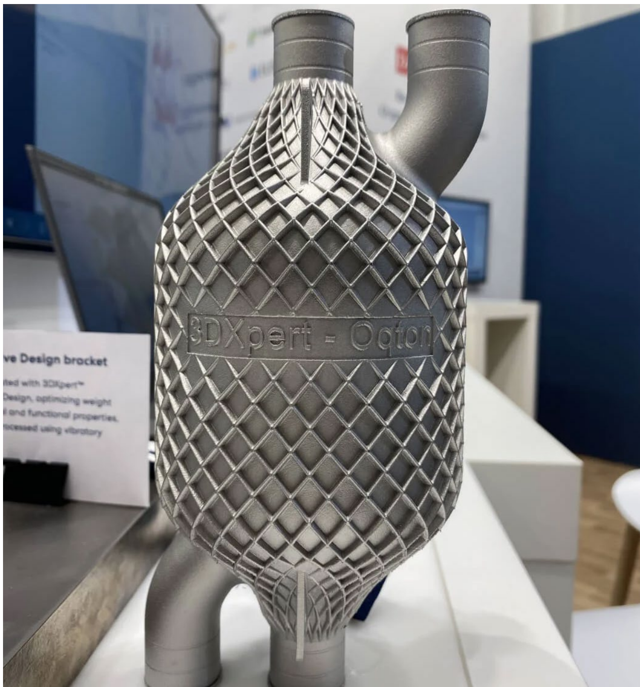
Рис. Результат печати после проектирования в ПО для «гибридного моделирования». Источник: Oqton 3DXpert
