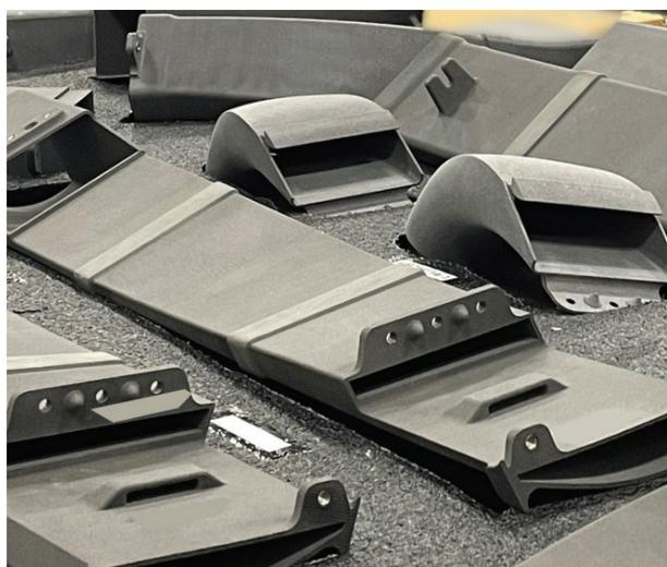
Рис. Напечатанные детали, ожидающие сборки.
