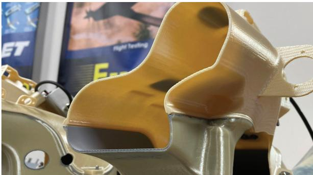
Рис. Воздуховод, напечатанный по технологии FDM.
