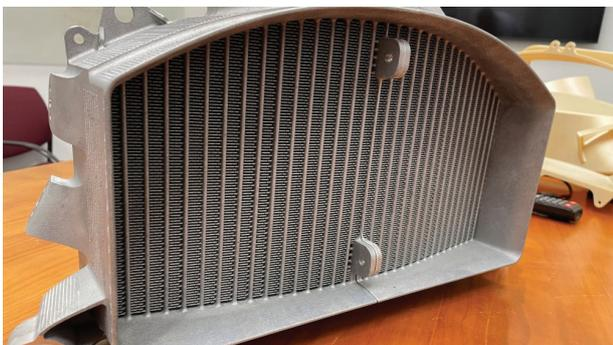
Рис. Теплообменник, напечатанный по технологии LB-PBF.
