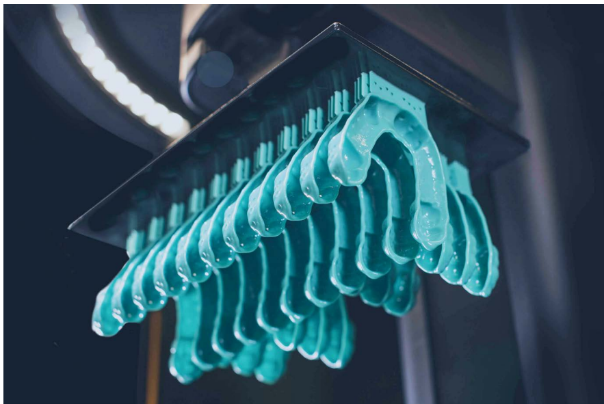
Рис. 4. Модели напечатаны на принтере M2 carbon [11]
