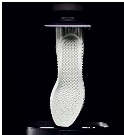
Рис. 3. Печать подошвы по технологии Carbon
