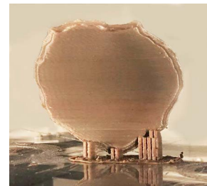
Анатомический имплант черепа Материал: PEEK Принтер: Anyform 650-PRO(Hot+)
