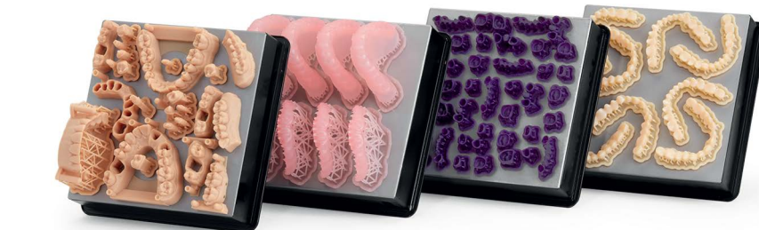
Рис. 5. Рабочие платы с напечатанными готовыми изделиями (принтер Form 2)
