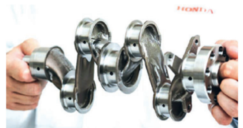
е) коленчатый вал ДВС, разработанный инженерами компании Honda, выполнено компаниями Autodesk и Honda [17]
