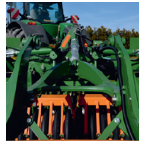
д) этапы изменения рамы навесного оборудования сельскохозяйственной машины (слева) и установленный элемент после изготовления по второму варианту (справа), выполнено в Altair OptiStruct/Inspire совместно с компанией Amazone [16]
