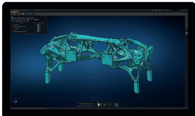
Рис. 3. Даже для сложной геометрии можно простым нажатием кнопки с помощью NURBS-преобразования получить твердотельную CAD-модель
