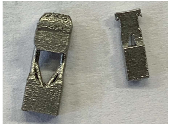
Рис. 4. Напечатанное металлическое изделие до и после обработки по технологии DryLyte
