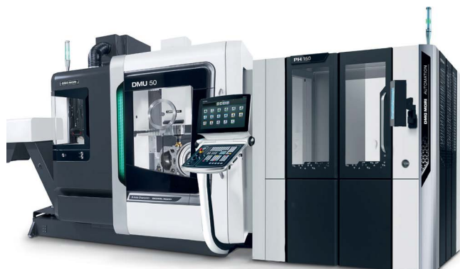
Рис. 3. PH 150 позволяет разместить до 24 палет. Максимальный размер палет \varnothing 500 \times 500 мм с весом заготовки до 250 кг.
