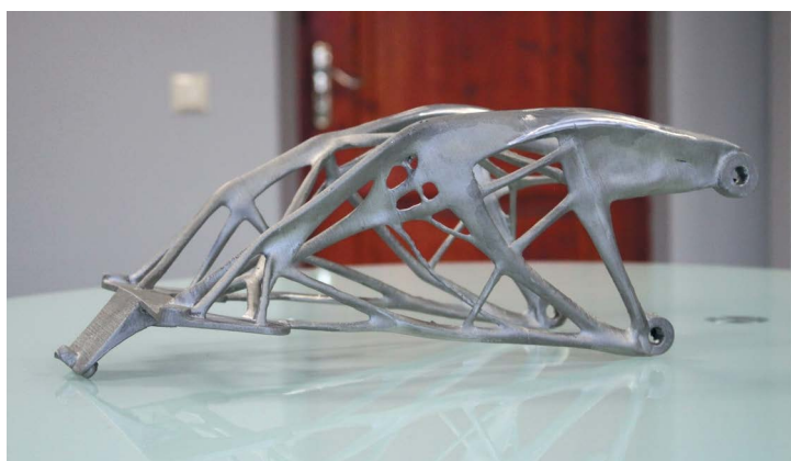
Часть спортивного мотоцикла, выполненная с использованием генеративного дизайна
