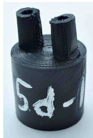
Рис. 6. Результаты сравнения механических свойств детали типа тела вращения: а) полученной методом стандартной 3D-печати; б) полученной методом 5D-печати
