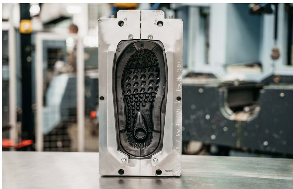
Индивидуализированная фотополимерная вставка в обувную пресс-форму. Фото: BUSINESS WIRE.
