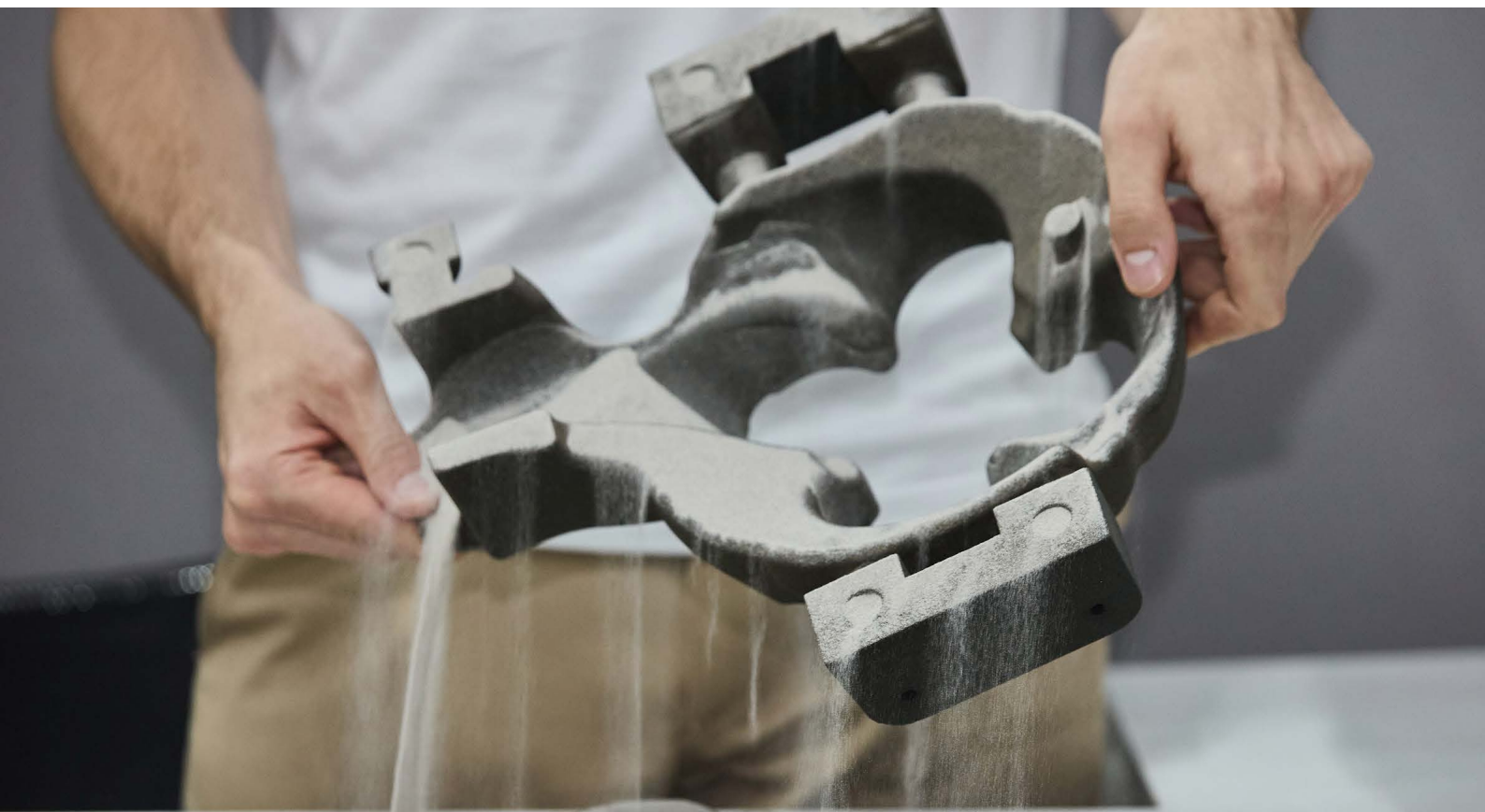
Технология ВJ – лучший способ для быстрого создания сложной оснастки из песка для передовых металлургических производств. Фото: СПИН7
