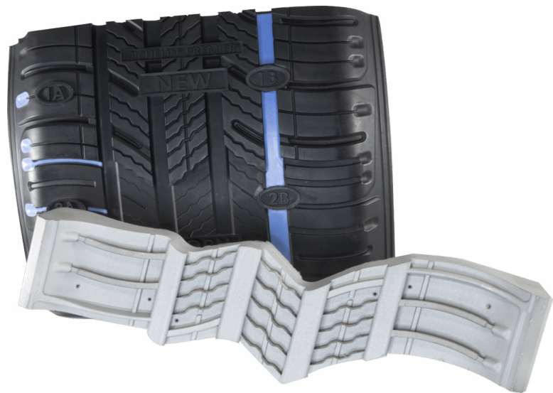
Пресс-форма с ламелями и готовая шинная продукция. Фото: AddUp.
