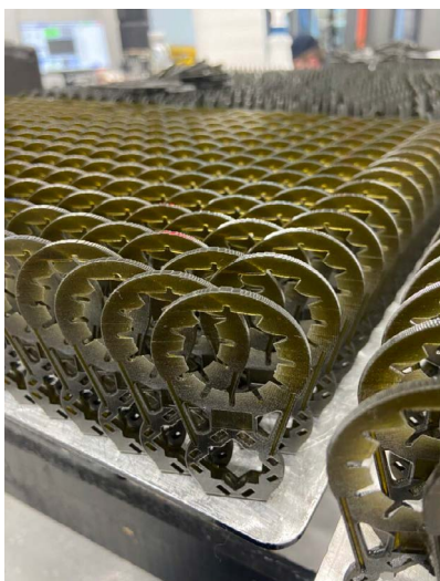
Серийное производство кронштейнов для крепления смесительной насадки. Фото: Merit3D.
