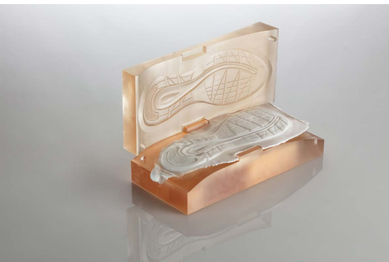
Фотополимерная пресс-форма и отлитая подошва. Фото: BASF.
