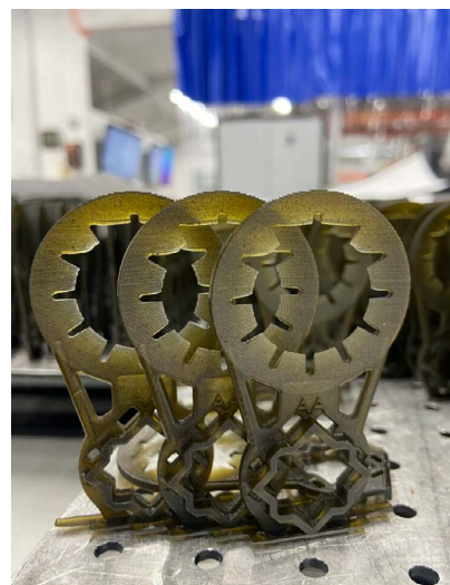
Серийное производство кронштейнов для крепления смесительной насадки. Фото: Merit3D.
