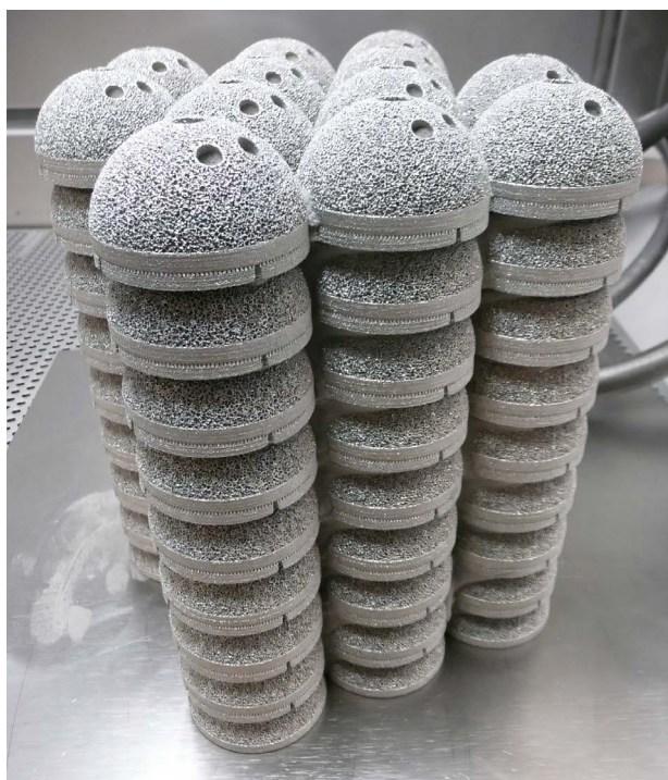
Производство ацетабулярных чаш по технологии ЭЛП. Фото: GE Aerospace.
