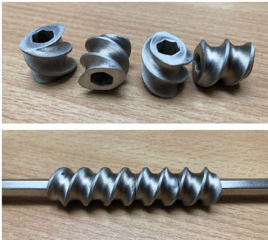
Сборный шнек гранулятора, изготовленный из стали 316L. Фото а – «зеленые» детали, b – спеченная деталь, два фото справа – спеченные детали и собранный шнек. Фото: Sascha Lenze.
