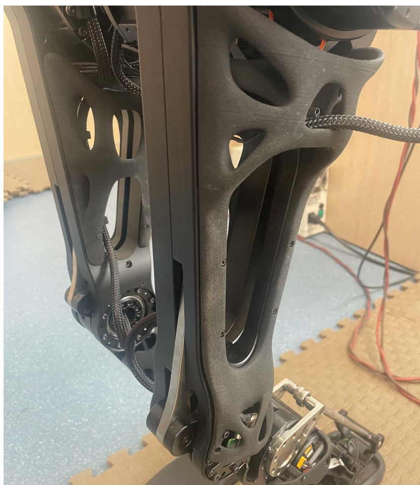
Внешние элементы корпуса робота, напечатанные по технологии SLS. Фото: МФТИ
