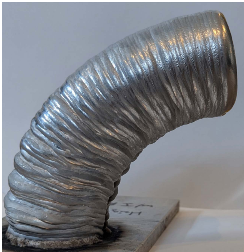
Изогнутая труба под углом 90°, изготовленная с использованием «холодной» модели с обратной связью
