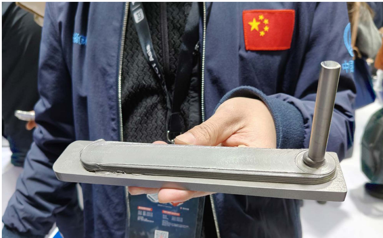
Технология FSW использует металлы и сплавы в практически любом состоянии (стружка, бруски, порошок), но удобнее всего работать со стержнями. Фото: Наиль Сабирьянов
