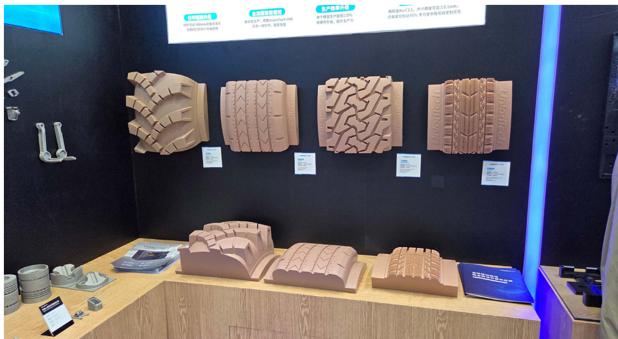
Образцы сложных шинных секторов пресс-форм UnionTech. Фото: Кирилл Казмирчук
