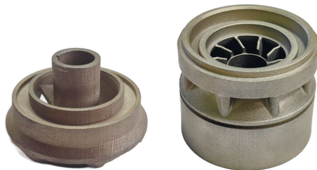
Рис. 2. Рабочее колесо и направляющий аппарат для ступеней ЭЦН, выполненные по МВJ-технологии
