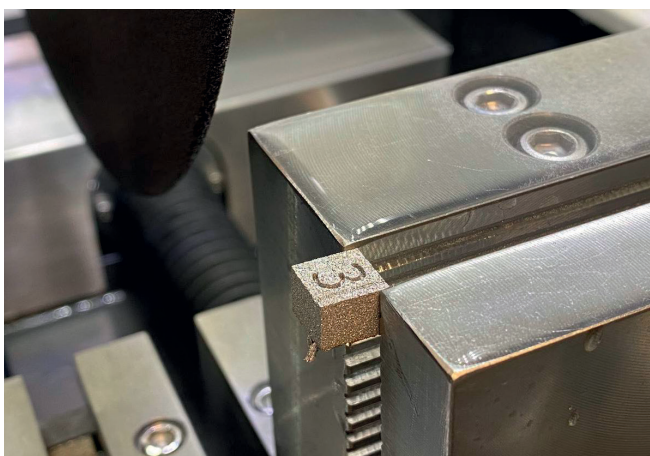
Рис. 8. Исследование в лаборатории металлографии: изготовление шлифов для определения пористости материала
