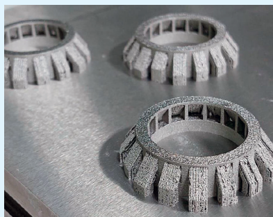
ПАО «Северсталь». Сепараторы для подшипников. Технология: SLM. Материал: CoCrMo. Печать: 3 часа. Количество: 3 шт.
