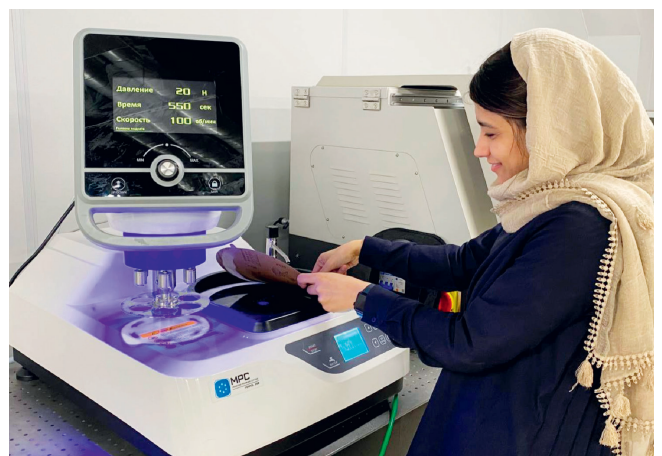
Рис. 8. Исследование в лаборатории металлографии: изготовление шлифов для определения пористости материала
