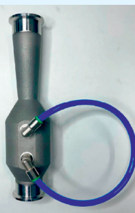
AM.TECH. Трубка Вентури – элемент системы контроля расходных скоростных характеристик газового потока. Технология: SLM. Материал: 12X18H10T. Время: 27 часов. Высота: 215 мм.
