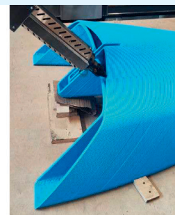
F2 innovation. Лодка. Материал: PETG+GF. Технология: FGF. Время печати: 50 часов. Габариты: 4*1,5*0,8 м. Вес: 200 кг.
