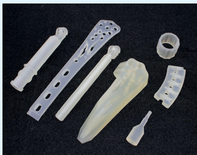
3DVision. Прототип корпуса. Технология: MJM. Материал: VisiJet M3 Crystal
