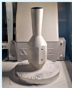
AM.TECH. Трубка Вентури – элемент системы контроля расходных скоростных характеристик газового потока. Технология: SLM. Материал: 12X18H10T. Время: 27 часов. Высота: 215 мм.
