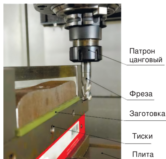
Рис. 4. Схема фрезерования периферией фрезы
