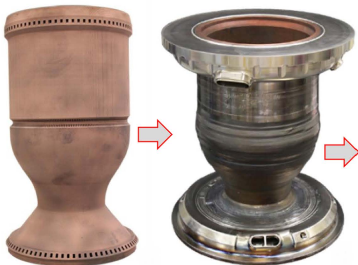
Биметаллическая камера сгорания: внутренняя часть изготовлена из сплава GRCo-84 по технологии L-PBF, а внешняя – из Inconel 625 по технологии EB-DED. Фото: NASA
