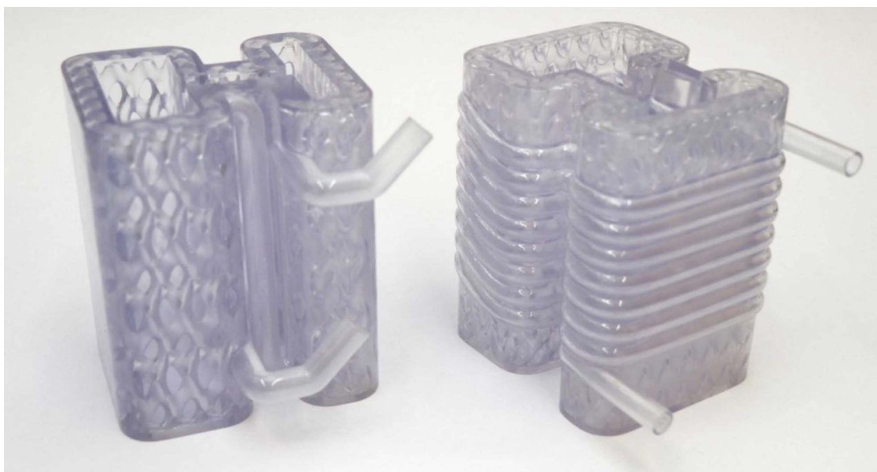
Напечатанные на 3D-принтере фотополимерные прототипы с концепцией горизонтальной и спиральной конструкции
