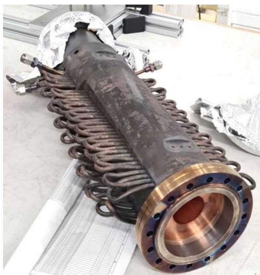
Пример традиционно изготовленного медного поглотителя с паянными в вакууме медными охлаждающими трубами (слева) и из нержавеющей стали (справа).
