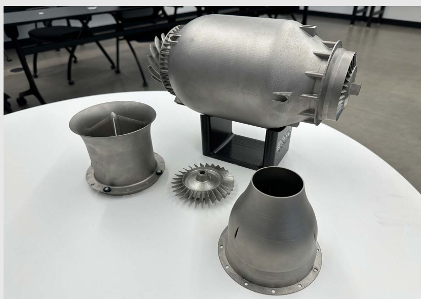
Одна из модификаций малогабаритного БПЛА-двигателя состоит из пяти деталей, изготовленных методом L-PBF. Фото: Beehive Industries
