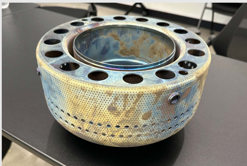
Ранний прототип камеры сгорания для демонстрационного двигателя с тягой 2224 ньютонов. Компания разработала и протестировала пять итераций конструкции всего за несколько месяцев. Фото: Beehive Industries
