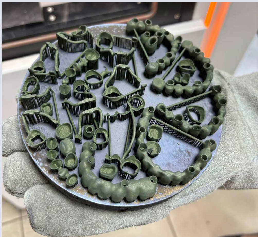
Напечатанные каркасы протезных конструкций и коронок из кобальт-хромового сплава. Фото: Урал3Д
