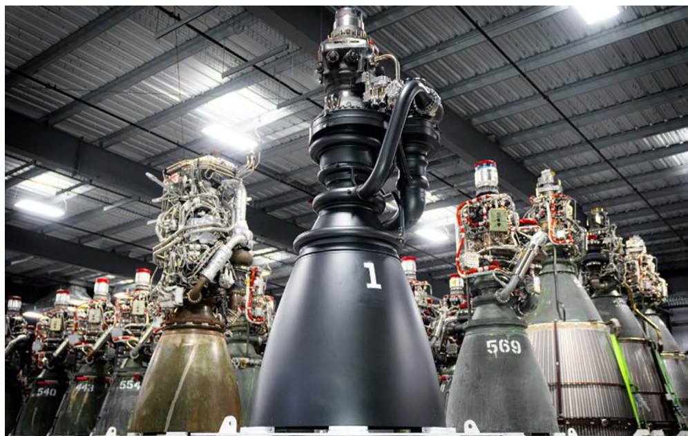
Минимизация количества компонентов в новом двигателе Raptor 3 по сравнению с Raptor 1 и 2 стала возможна благодаря аддитивному производству. Фото: SpaceX
