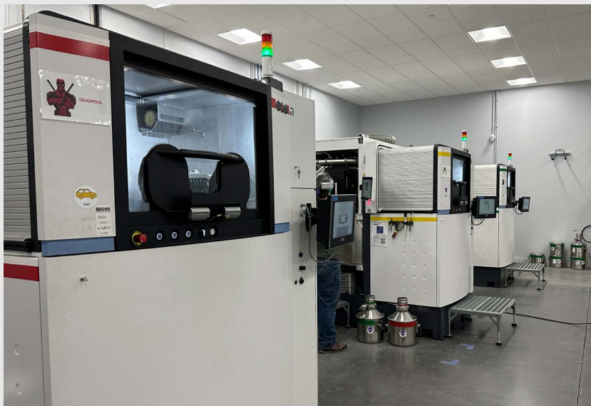
Аддитивное производство осуществляется по технологии L-PBF на установках EOS различных размеров с использованием титановых, алюминиевых и никелевых сплавов. Фото: Beehive Industries
