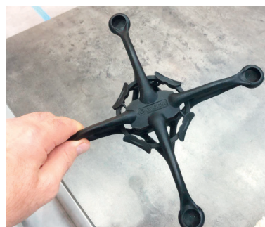
Рис. 3. Корпус БПЛА материал (PEEK-CF). Изготовлен на 3D-принтере Funmat Pro 610HT. Фото: Intamsys
