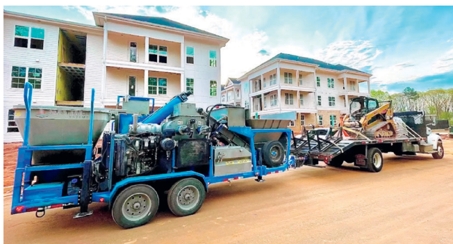
Рис. 12. Оборудование для строительной 3D-печати, размещенное на трейлере
