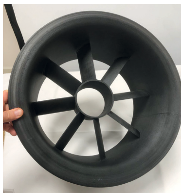
Рис. 6. Воздухозаборник БПЛА Cavorite X5 из угленаполненного полиэфирэфиркетона (PEEK-CF), изготовленный на 3D-принтере Funmat Pro 410. Компания Horizon Aircraft (Канада). Фото: Intamsys
