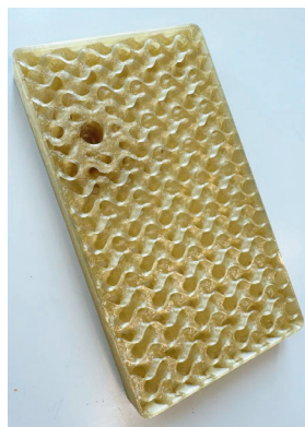
Рис. 4. Ячеистые структуры, части корпуса БПЛА (материал PEEK). Изготовлены на 3D-принтере Funmat Pro 610HT. Фото: Intamsys
