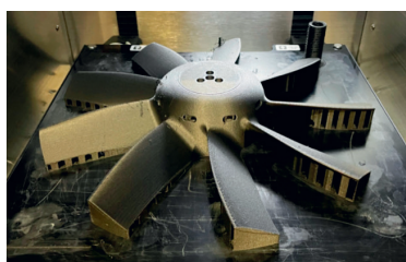
Рис. 7. Крыльчатка БПЛА Cavorite X5 из угленаполненного полиэфирэфиркетона (PEEK-CF), изготовленная на 3D-принтере Funmat Pro 410. Компания Horizon Aircraft (Канада). Фото: Intamsys
