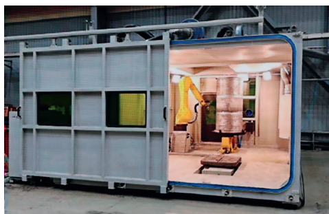
Рис. 8. Реализация технологии прямого лазерного выращивания из алюминиевых сплавов для изготовления крупногабаритных оболочек ракет. Фото: СПбГМТУ
