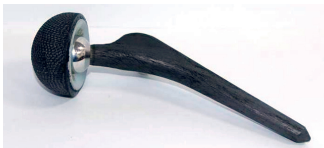
Рис. 9. Эндопротез ТБС с ножкой из «Углекон-МВ» и чашкой из «Углекон-МТ». Из презентации Ю. Уткина
