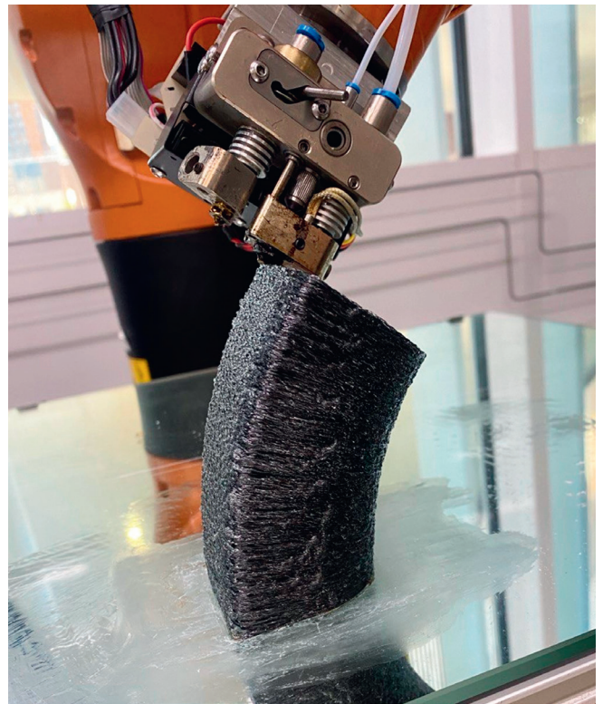
Рис. 7. Многоосевая композитная 3D-печать с применением промышленного робота
