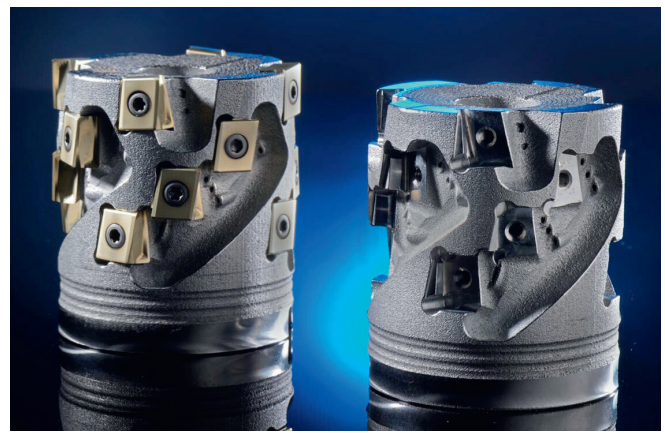
Рис. 6. Концевая фреза и расположение каналов для СОЖ
