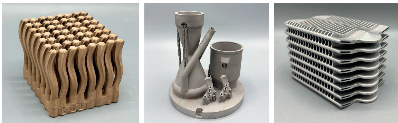
Изделия сложной геометрической формы: 1 — радиатор охлаждения из медного сплава, 2 — камера сгорания ракетного двигателя из жаропрочного сплава, 3 — жидкостный теплообменник из алюминиевого сплава
