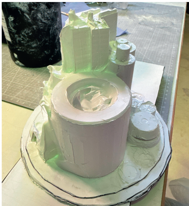
Рис. 1. Экспериментальные сопловой аппарат и колесо турбины, выполнены ООО «Ретех» («Прокерамика») в рамках индустриального НИР с АО «ЦАТ» ГК «Ростех» и СамГТУ (после печати, до спекания)
