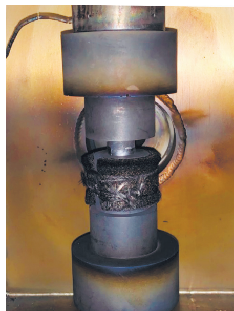
Рис. 6. Фотография установленной пресс-формы с войлочной изоляцией в камере спекания
