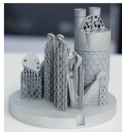
Рис. 5. АТ в прототипировании сложных устройств космической отрасли. Образец выполнен компанией «Онсинт»
