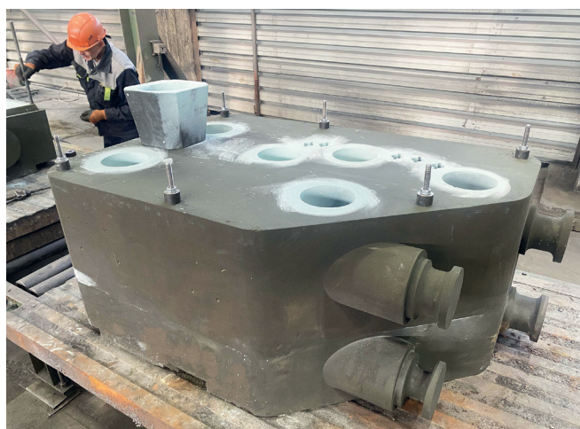
Песчано-полимерные формы напечатаны на оборудовании Kocel
