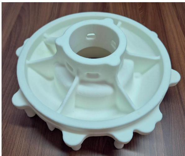
Формы из ПММА напечатаны на оборудовании FHZL
