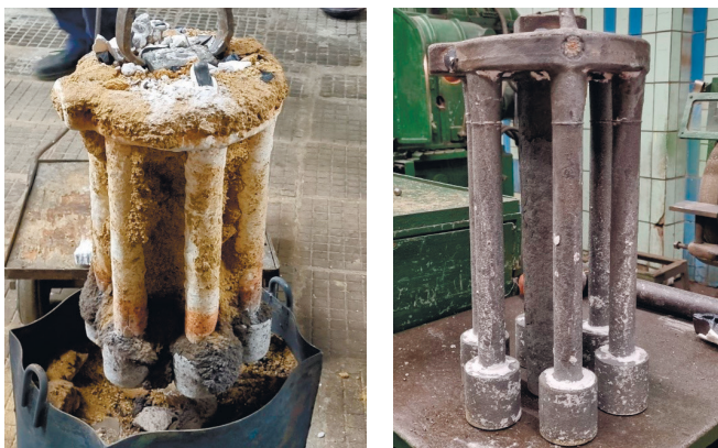
Рис. 5. Отливка до удаления остатков керамики
