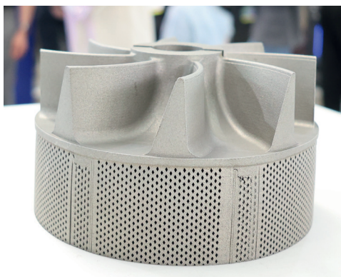
Рис. 1. Импеллер – выполнен «РосАТ» по SLM-технологии.
