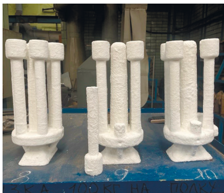
Рис. 3. Оболочковые формы отливки «Пуансон»
