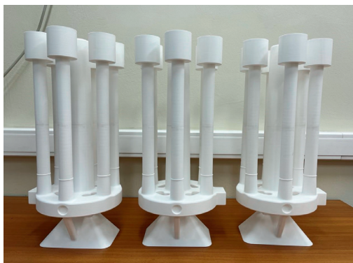
Рис. 2. Модельные блоки отливки «Пуансон», напечатанные из полимера по технологии FDM-печати
