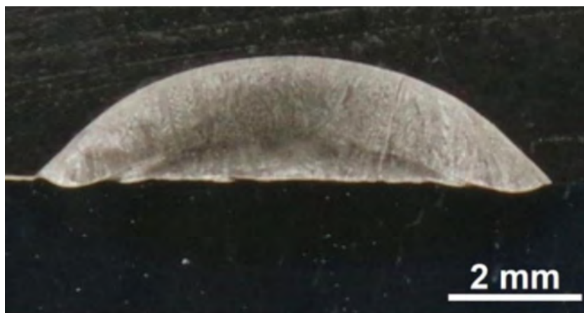
Поперечное сечение промежуточного слоя из сплава на основе Ni
