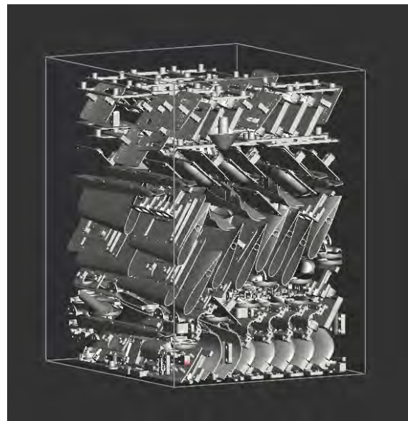
Промышленный SLS-принтер: типичная компоновка бункера печати
