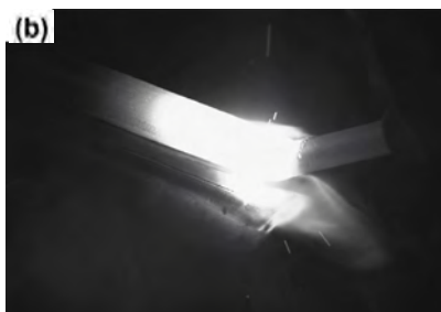
(а) Внешний вид изделия из твёрдого сплава, изготовленного методом с опережающим прутком. (b) Снимок высокоскоростной камерой процесса формирования методом с опережающим прутком
