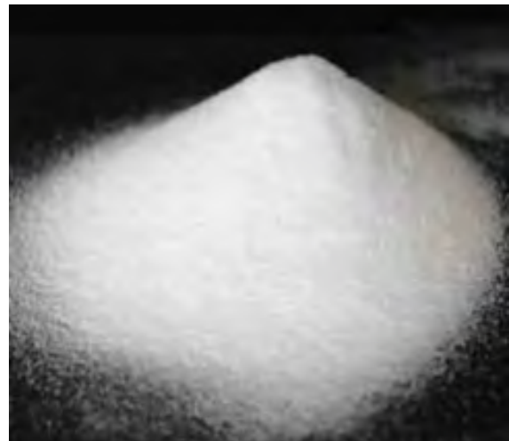
Полимерный порошок для SLS-печати: пример термопластичной порошковой полимерной композиции на основе полиамида
