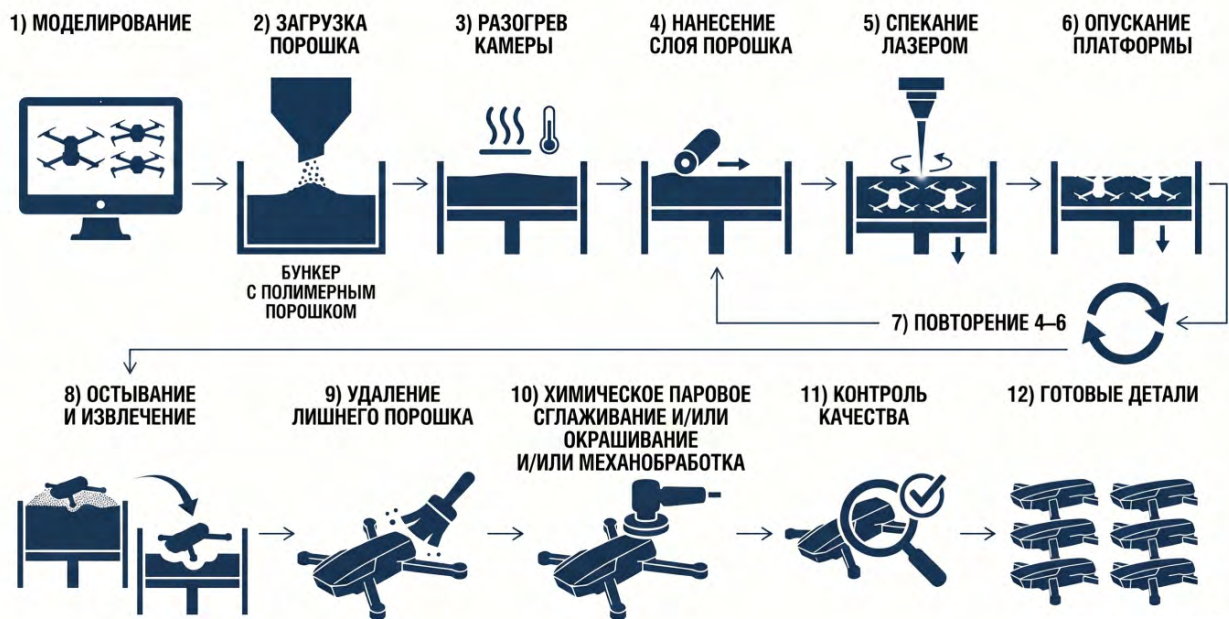
Процесс производства деталей по технологии SLS
