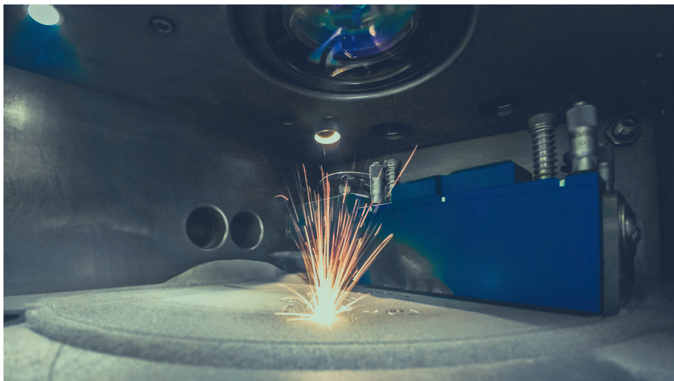
Рис. 1. В фокусе статьи: моделирование SLM / LPBF / DMLS — лазерного сплавления металлического порошка в порошковом слое
