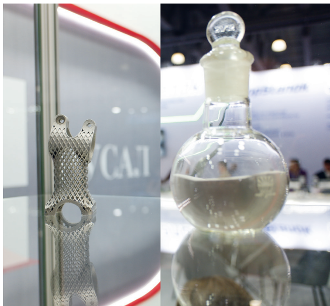
Рис. 2. Алюминиевый порошок для 3D-печати производства компании «РУСАЛ» и изготовленный из него кронштейн
