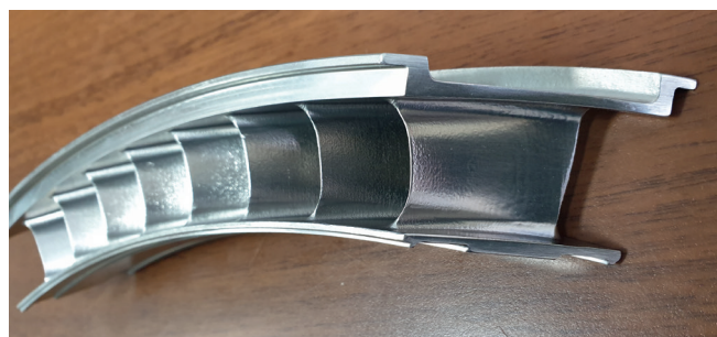
Рис. 7. Сегмент авиадвигателя. 3D-печать, Ra 0,8 после обработки АЭХ
