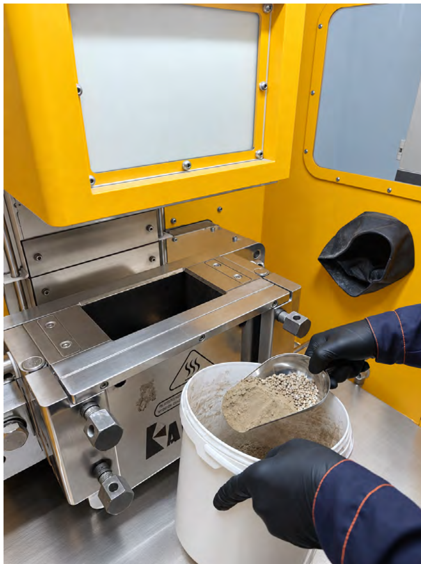
Подготовка бронзонаполненной композиции.
