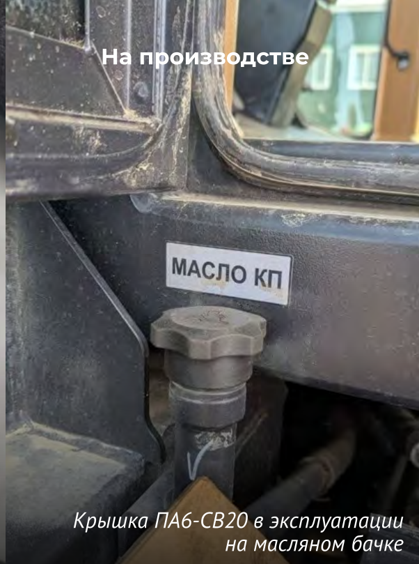
Крышка, напечатанная из ПА6-SB20
