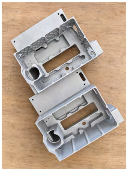
Исходный и облегчённый корпус блока управления лебёдки.
