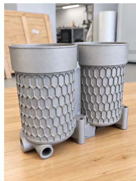
Корпус масляного фильтра после облегчения: 2500 г.
