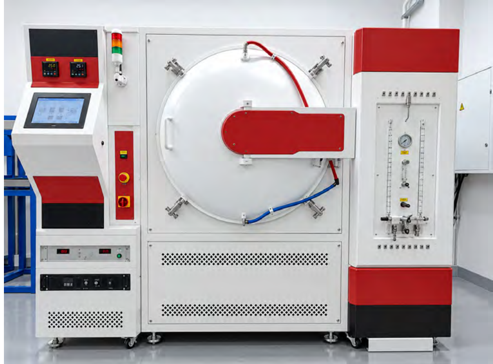
Вакуумная печь на участке постобработки. Термическая обработка является частью технологического маршрута многих металлических SLM-деталей.
